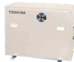
Dvoustupňové tepelné čerpadlo jako hydromodul, pro vysokoteplotní ohřev topné vody. Určen pro 3trubkové systémy se zpětným využitím tepla a napojení na externí topný systém včetně jeho komponent.
