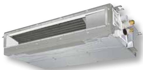
Mimořádně nízká výška a kompaktní design. Pro velmi malé místnosti je k dispozici jednotka s výkonem pouze 0,9 kW. Vzduchový filtr a čerpadlo kondenzátu s výtlachou výškou 350 mm (součásti dodávky).
