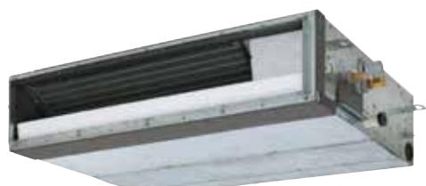
Extrémně nízké provedení. Vysoká energetická účinnost a čerpadlo kondenzátu s dopravní výškou až 850 mm. Sání ze spodní části nebo ze zadní části jednotky.
