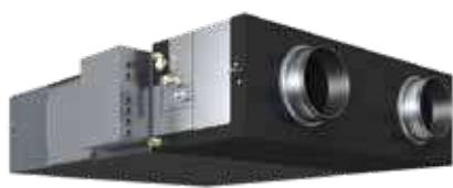
Rekuperační jednotky s křížovým výměníkem nabízejí přívod čerstvého vzduchu včetně dokonalé rekuperace tepla mezi přívodem a odtahem z prostoru s účinností až 75 %.
